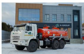
**Автотопливозаправщик АТЗ-11/2 (2 секции) на шасси Камаз 43118-50**
