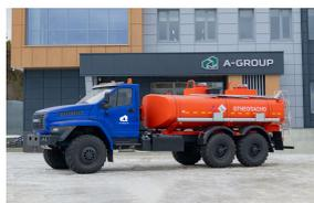
**Автотопливозаправщик АТЗ-10/2 (2 секции) на шасси УРАЛ NEXТ 5557-72**
